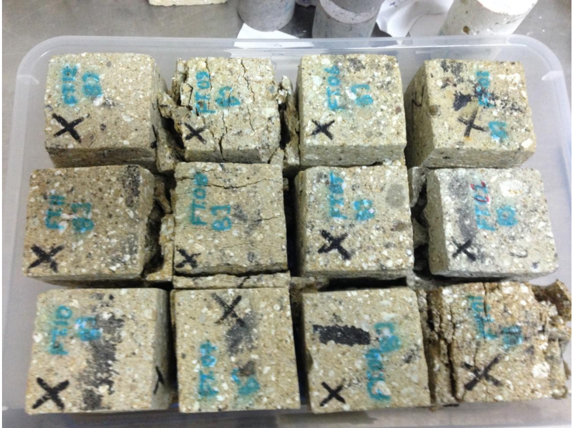
Resim 4.5. BJ kodlu örnekler X düzlemine dik yönde gelişen ayrılmaların genel görünümü (donma-çözülme)
