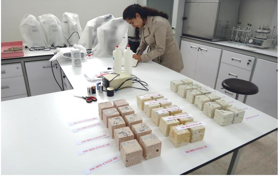
Resim 3.2. P-dalga hızının ölçümünden genel görünüm
