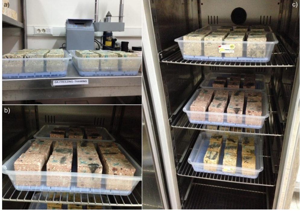
Resim 3.4. Donma-çözülme deneyin yapımından genel görünüm
