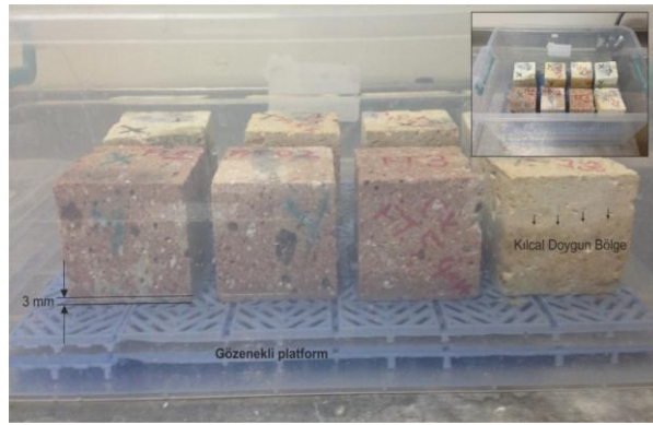
Resim 3.6. Kılcal etkiye bađlı su emme deneyinden bir görünüm
