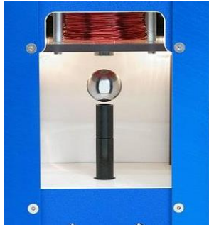
Şekil 7: Quanser manyetik kaldırma sistemi
