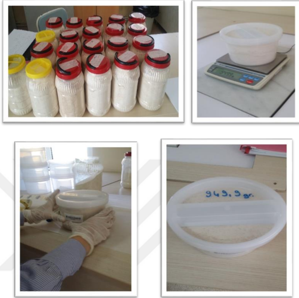
Şekil 3.5. Fasulye Bitkisi Örneklerinin Gama Spektrometrik Analiz İçin Hazırlık Aşamaları
