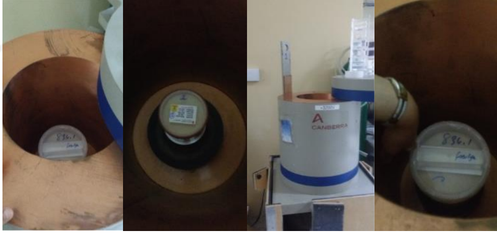
Şekil 3.6. Gama detektöründe verim kalibrasyonu işlemi
