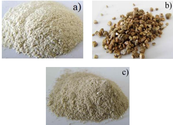
Şekil.1 Kullanılan hammaddeler: (a) diatomit (Kizelguhr), (b) genişletilmiş vermikülit, (c) bağlayıcı refrakter kil.
