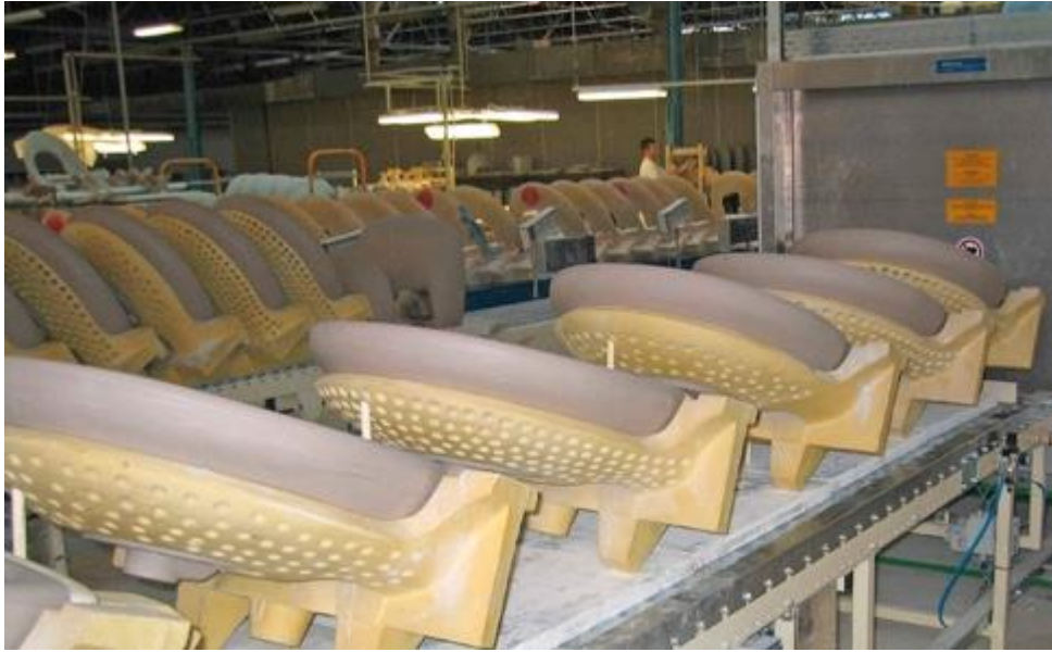
Resim 84. Seri üretim yöntemiyle üretilen yarı mamül lavabolar.
